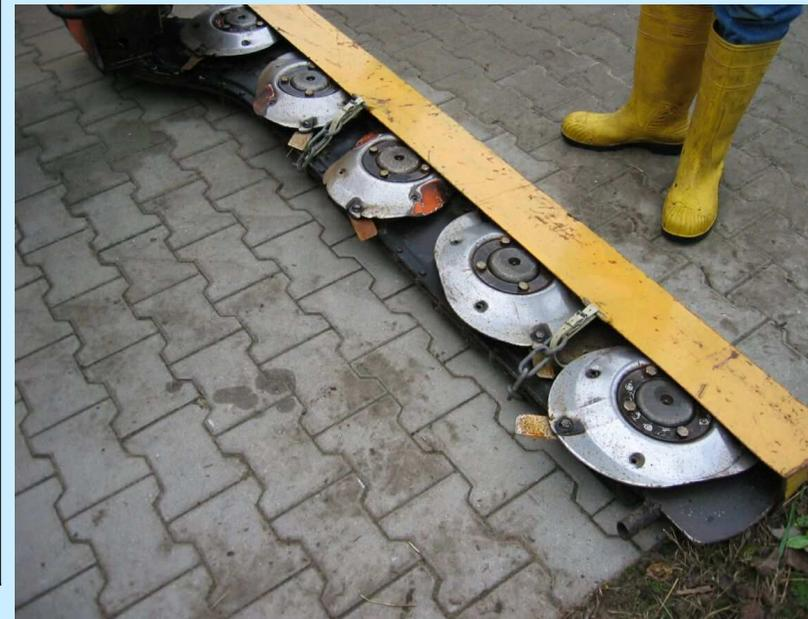
Kreiselmäherwerk für die Gewässerrandstreifen, um anschließend das Mähgut zu schwaden und aufzupressen
