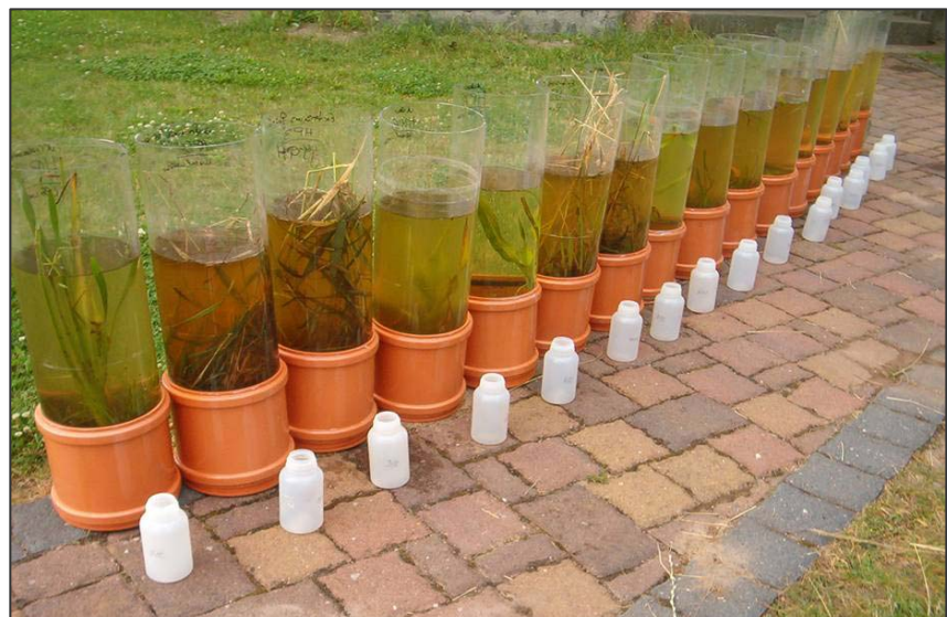
Abbildung 3-1: Säulenexperimente auf dem Gelände der IaG GmbH (Foto: LOTSCH/ SKRADDE 2005)
