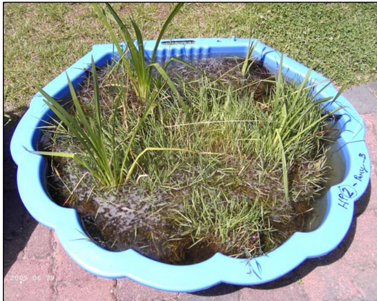
Abbildung 3-10: 110 l-Beprobungsgefäß befüllt mit HP 2/5 und 50 l Havelwasser (Foto: SKRADDE 2005)
