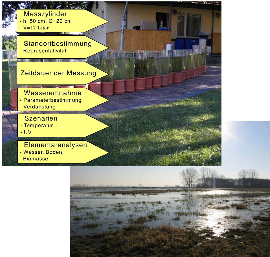
Abbildung 8: Säulenversuche zur Polderflutung am IaG, Feldversuche
