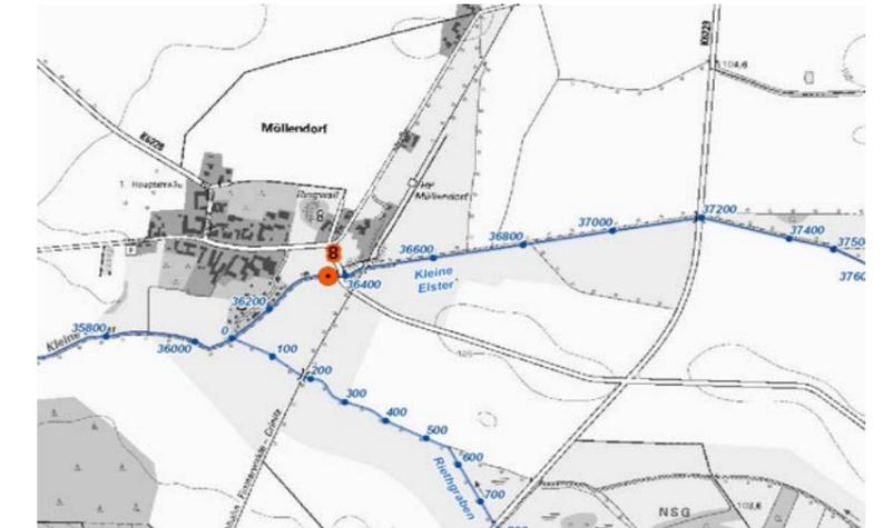
**Messung 2** \* Messstelle um ca. 20 m stromaufwärts versetzt wegen turbulenter Fließverhältnisse im Wehr; neue Messstelle im Unterstrom der Straßenbrücke
