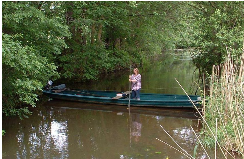
Abbildung 5.5: v-Messung im Großen Fließ mit induktiver Messsonde (Nautilus C2000, Ott)
