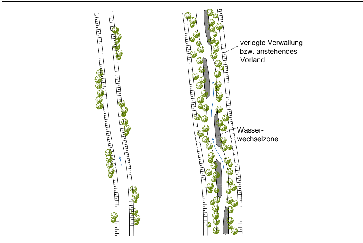
Abbildung 7-1: linke Prinzipskizze: Ist-Zustand des Gewässers; rechte Prinzipskizze: hergestellte Wasserwechselzone mit standorttypischer Bepflanzung (Quelle: eigene Darstellung)
