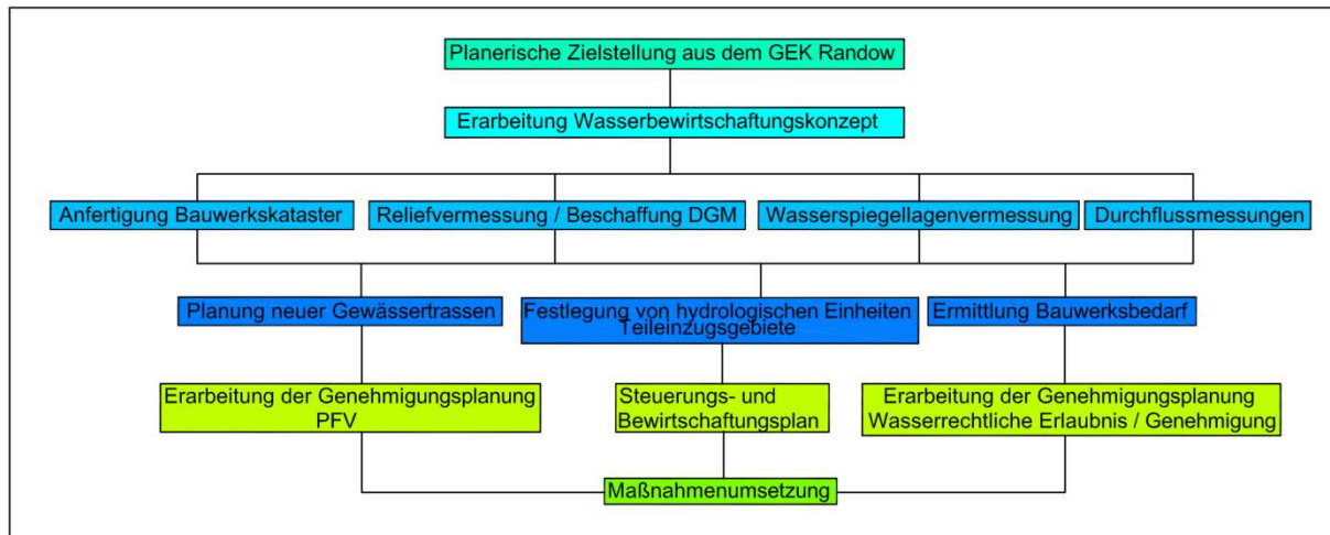
Abbildung 7-4: schematische Darstellung des Bearbeitungsablaufes von den Zielen des Gewässerentwicklungskonzeptes bis zur Maßnahmenumsetzung (eigene Darstellung)
