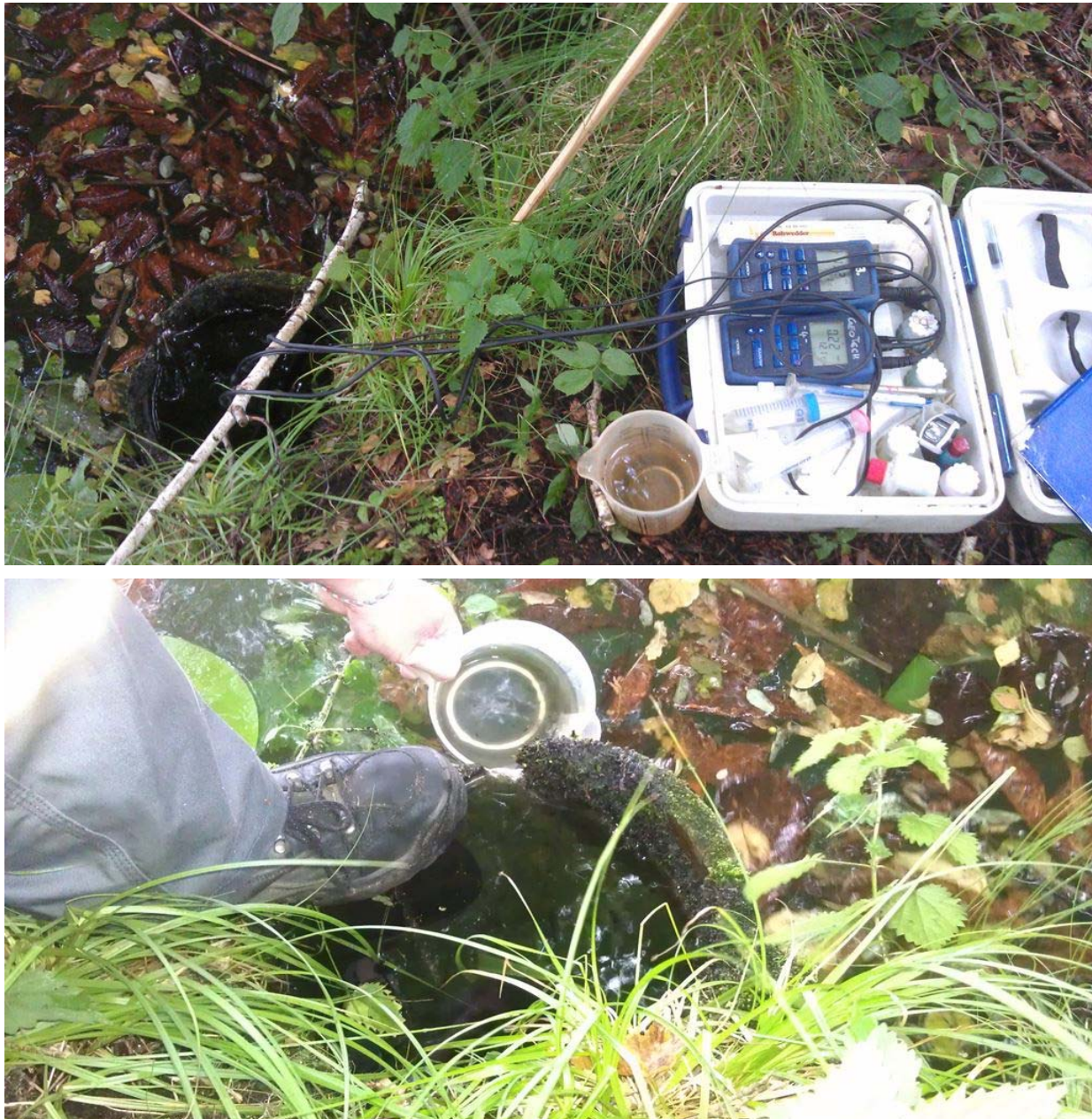
Abb. 17: Beprobung des gefassten Quellaustritts am südwestlichen Ufer des Großen Mochowsees
