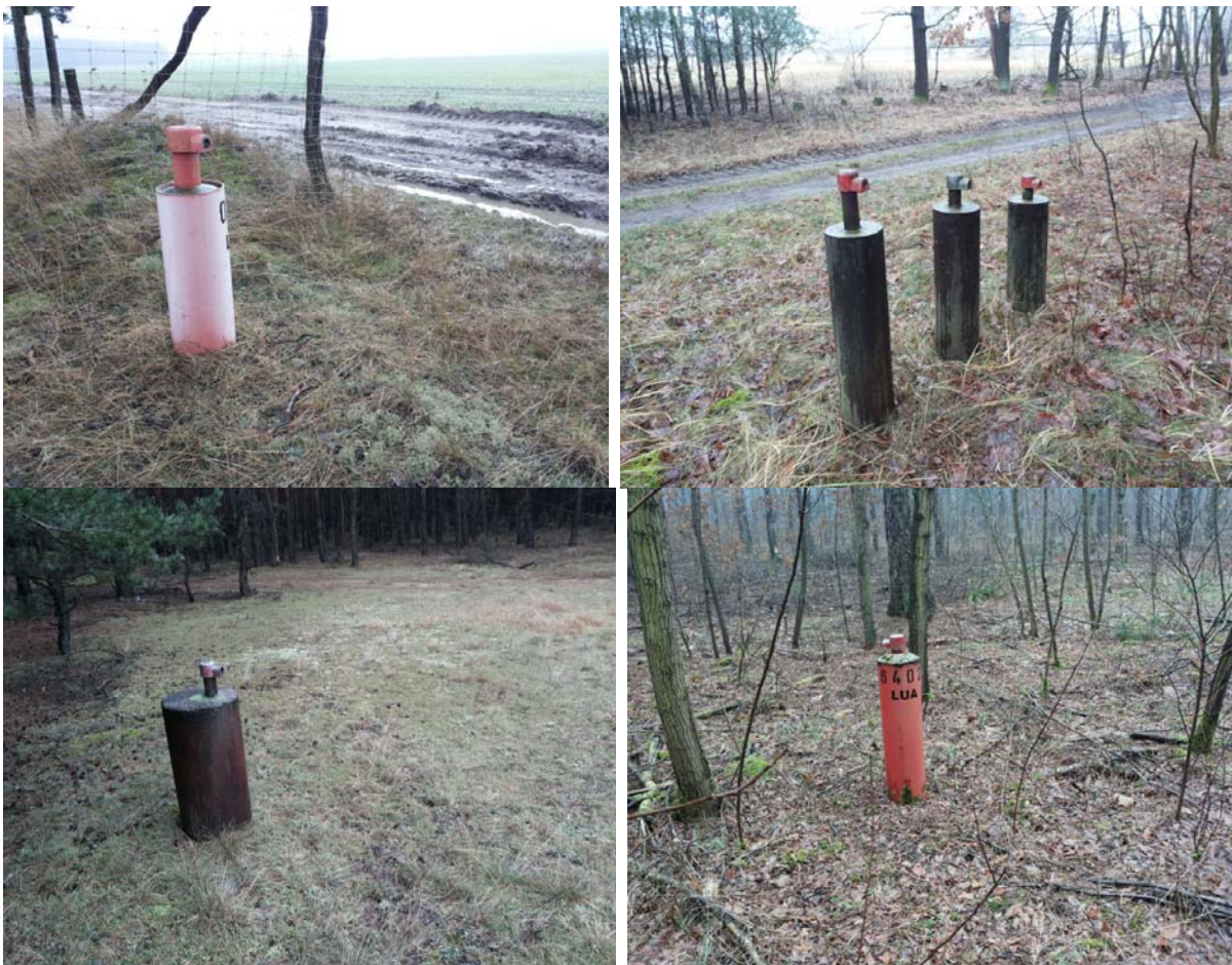
Abb. 12: Exemplarische Fotos geeigneter (oben) und ungeeigneter Messstellen (unten); die vollständige Dokumentation samt Messstellenbezeichnung befindet sich im Anhang 2
