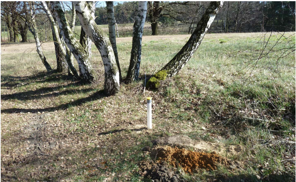
Abb. 15: Temporäre Grundwassermessstelle RKS 1 nordöstlich von Mochow am Südwestufer des Großen Mochowsees
