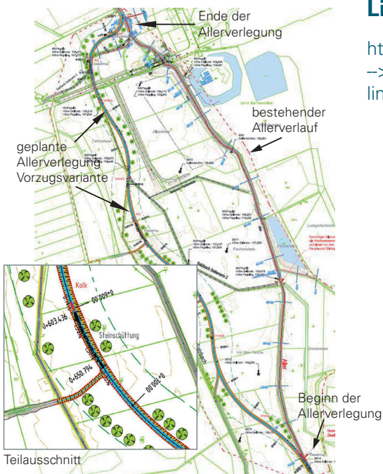
Geplante Allerverlegung Vorzugsvariante / Teilausschnitt
