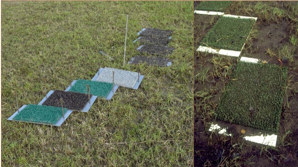
Abbildung 5: Kunstrasen-Sedimentfallen im Elbevorland.
