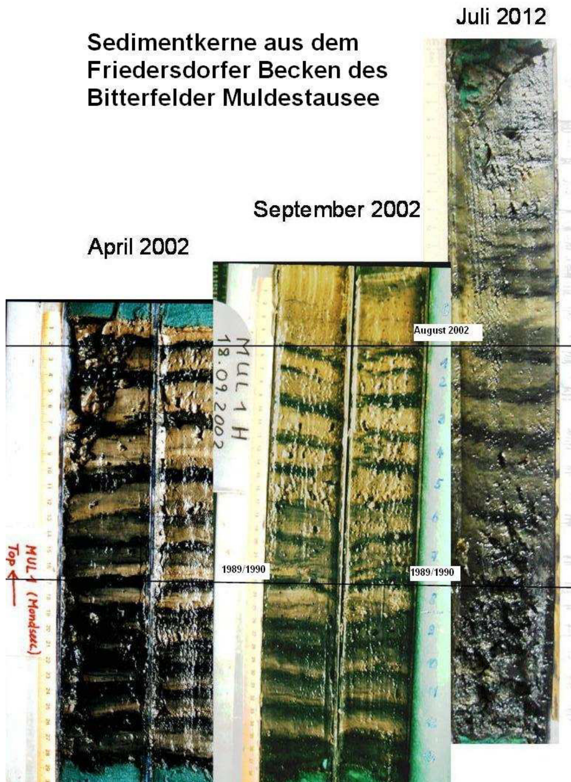
Abb. 8: Aufbau und Korrelation des Seesedimentes in zu unterschiedlichen Zeitpunkten entnommenen Sedimentkernen aus dem Friedersdorfer Becken des Bitterfelder Muldestausees (links: Kern Mul1 vom April 2002; Mitte: Kern Mul1HW vom September 2002; rechts: Kern MuSt-FB7). Hochwasserlagen (hell) unterbrechen die organische Sedimentation (dunkel).
