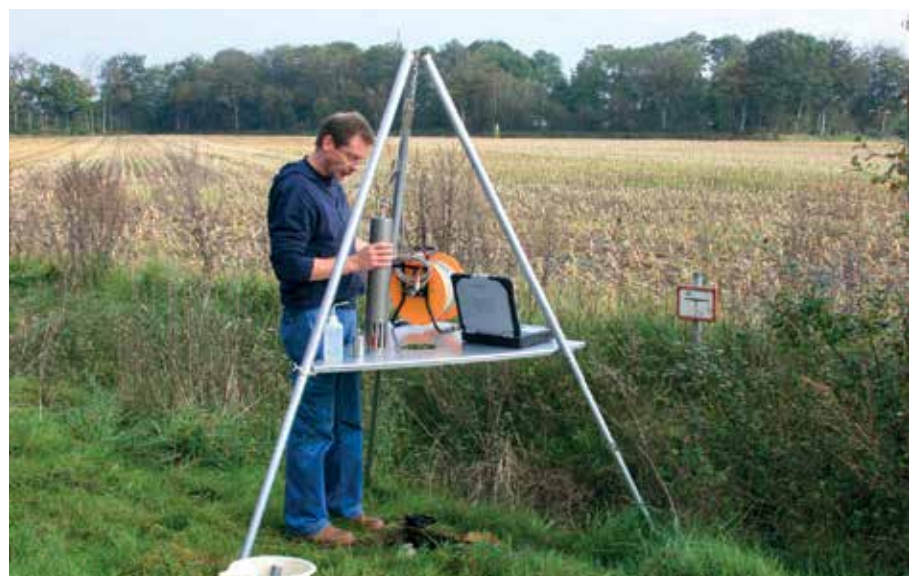
Vorbereiten der Grundwassersonde
