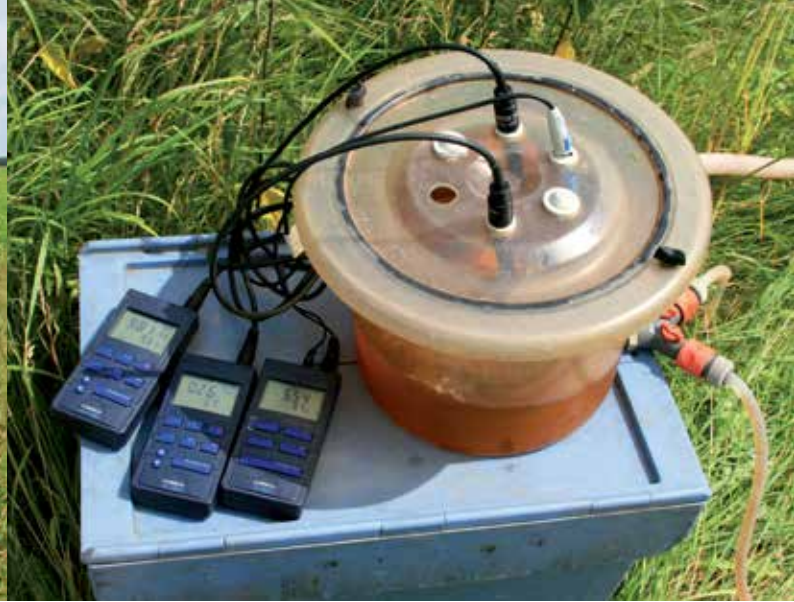
Grundwasserprobe- nahme: Messung der Leitfähigkeit in unterschiedlichen Tiefen
