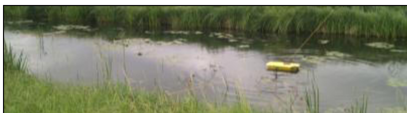
Abbildung 38: Messung mit dem QLiner2 der Firma OTT im Unterlauf der Karthane. Foto: DHI WASY 06.07.2012.
