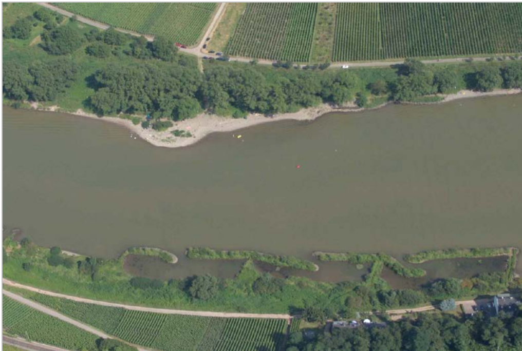
Bühnenfelder und Flachwasserzonen in der Mosel bei Pünderich (Quelle: WSA Koblenz)
