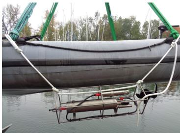
Schlauchboot mit Multiparametersonde,
