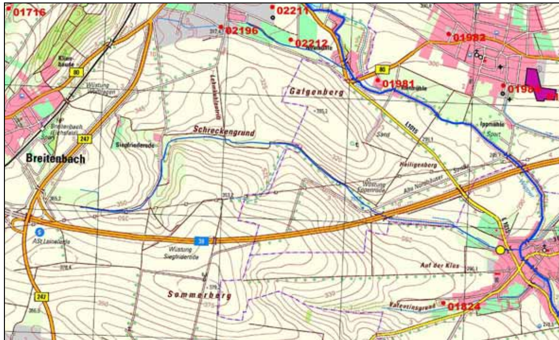
Abbildung 5.12 Beispiel 11: Messstellenausschluss (gelb) aufgrund hoher Verkehrsdichte im Einzugsgebiet (Autobahn und Bundesstraße)
