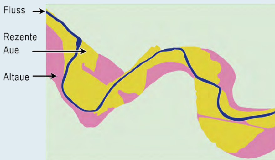
Abb. 5: Rezente Aue und Altaue bilden die morphologische Aue – schematische Darstellung (BMUB & BfN 2009, verändert).
