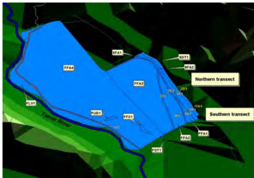
Abbildungen: Der WEDSS-Input-Layer (links) zeigt die zu bewertenden hydrogeomorphologischen Einheiten des Feuchtgebiets (blau), der Output-Layer (rechts) das Ausmaß der Denitrifizierung in diesen Einheiten (die Entstickung ist wichtig für die Verbesserung oder den Erhalt der Wasserqualität und ist stärker in den dunkleren Gebieten)
