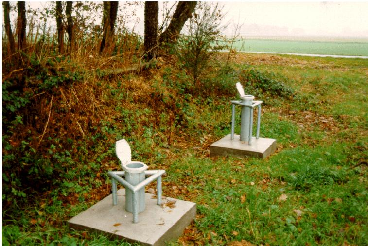
Abbildung 4-1: Grundwassermessstellen
