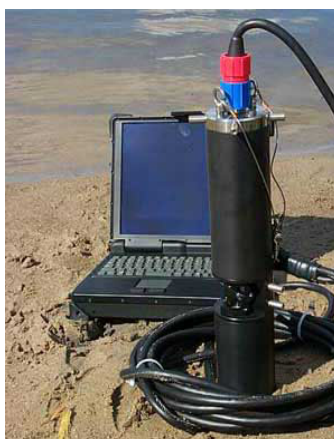
Abbildung 2: Tauchsonde zur in-vivo-Fluoreszenzmessung
